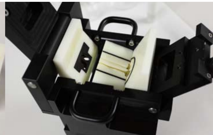
In einem unscheinbaren schwarzen Kasten (rechts) verbirgt sich eine künstliche Nase, die exakt die anatomischen Gegebenheiten darstellt. Dr. Regina Scherließ testet damit, wo das Pulver hängen bleibt, wenn sie es in die Nasenlöcher sprüht. Das Modell lässt sich in einzelne Teile zerlegen (Mitte). Hier sieht man die oberen und unteren Nasengänge im Querschnitt. Fotos: pur.pur
