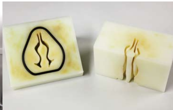
In einem unscheinbaren schwarzen Kasten (rechts) verbirgt sich eine künstliche Nase, die exakt die anatomischen Gegebenheiten darstellt. Dr. Regina Scherließ testet damit, wo das Pulver hängen bleibt, wenn sie es in die Nasenlöcher sprüht. Das Modell lässt sich in einzelne Teile zerlegen (Mitte). Hier sieht man die oberen und unteren Nasengänge im Querschnitt. Fotos: pur.pur
